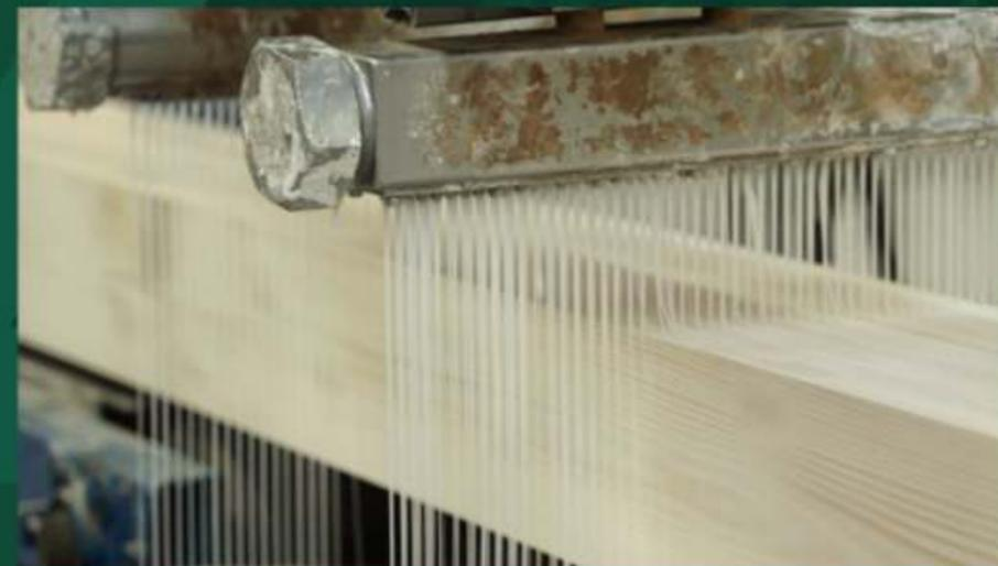
Сращивание заготовок в гидравлическом прессе в ламели длиной до 15 м
