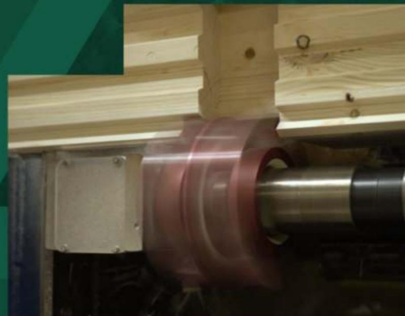
Брус сегментируется на детали согласно спецификации. Нарезаются чаши, отверстия, пазы, монтажные соединения. Торцуются края
